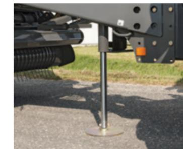
Pata hidráulica de apoyo.
