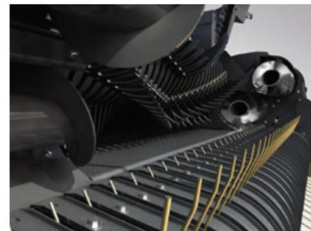
Las empacadoras de picador cuentan además con sinfines «Quad» que garantizan una entrada consistente de material en el rotor ProCut.
