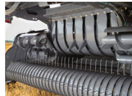
Cuatro sinfines «Quad» garantizan una mayor capacidad de alimentación en las empacadoras tipo «Packer».
