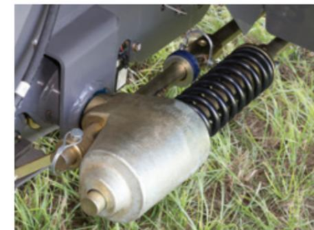
La amortiguación del pick-up mediante resorte de compresión está diseñada para un funcionamiento a alta velocidad.
