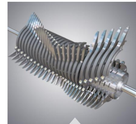
Resistente rotor de alta velocidad y gran diámetro, con secciones de dedos reemplazables
