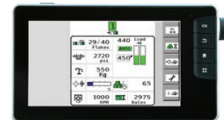
Control automático de densidad a través del terminal para empacadoras FieldStar 5.
