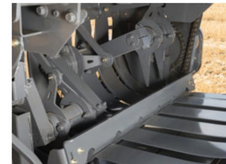
Las púas del de la horca de alimentación garantizan una entrada uniforme de material en la precámara de compresión.
