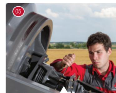
05 Ajuste del embrague deslizante del volante.
