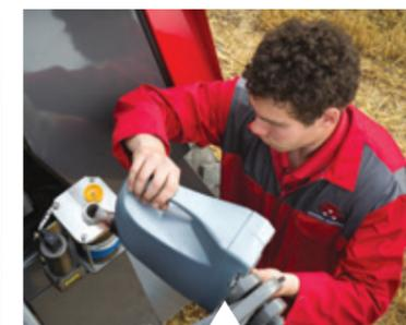
Rellenado del lubricante automático de la cadena.
