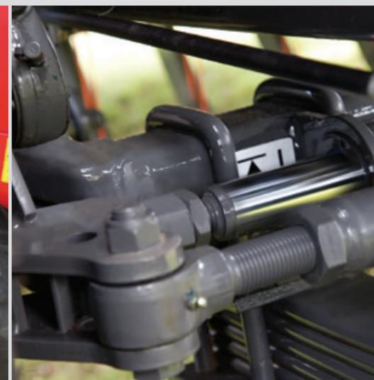
Bloqueo de dirección hidráulico en el eje trasero.
