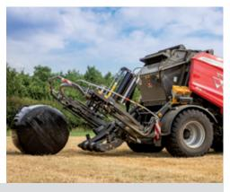
Para garantizar una descarga cuidadosa de las pacas, la mesa de encintado baja su altura casi hasta el suelo, minimizando así la velocidad de rodadura de la paca, evitando dañar la película y preservando una forma ideal de la paca. Un volquete opcional evita que las pacas salgan rodando y facilita la posterior carga en el remolque. El operario puede elegir entre un modo de descarga automático o manual.
