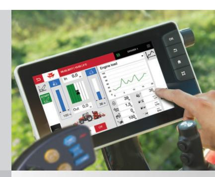
La roto-empacadora combinada MF 4160V Protec puede solicitarse con conexión ISOBUS para poder emplear monitores en el tractor.
