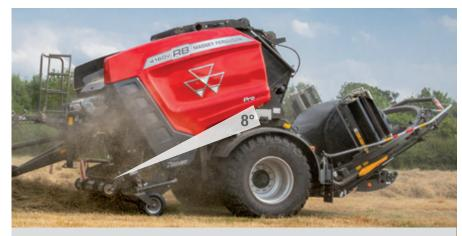
La nueva unidad combinada Protec cuenta con un menor ángulo de elevación del cultivo, lo que reduce la altura total de la roto- empacadora. Esta característica mejora la estabilidad, además de agilizar las operaciones en pendiente y aumentar la seguridad. Además reduce la presión en la zona de alimentación, lo que optimiza el flujo de cultivo y minimiza el riesgo de obstrucciones.
