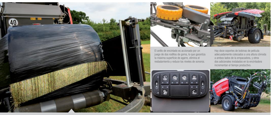
La mesa de encintado de accionamiento hidráulico consta de dos cilindros y tres correas montadas en un bastidor soldado para proporcionar una mayor durabilidad. Un sensor debajo de la correa central permitirá que el encintado dé comienzo únicamente cuando la paca esté totalmente posicionada sobre la mesa, mientras que cuatro rodillos de sujeción laterales mantienen la paca centrada durante el encintado.
