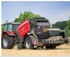
Una vez la paca se ha transferido al centro de la mesa de encintado, un anillo de encintado de accionamiento hidráulico empieza a girar incluso antes de que el portón trasero se cierre totalmente, completando de esta manera el ciclo mucho antes de que la siguiente paca esté lista para el encintado. El robusto bastidor, diseñado para resistir las cargas más altas, opera con la máxima suavidad para proporcionar un encintando sin problemas, paca tras otra.
