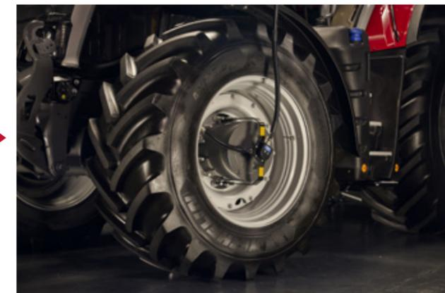
El sistema central de inflado reduce el consumo de combustible entre un 10 y un 15 % y reduce la compactación al proporcionar una huella hasta un 150 % más grande. Al mismo tiempo, puede incrementar la tracción y reducir el desgaste innecesario de los neumáticos.
