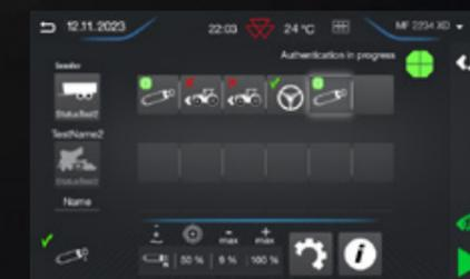
El nuevo sistema de control del tractor desde el apero (ISOBUS TIM), proporcionado por el sistema TIM ISOBUS, gestiona de forma automática funciones del tractor tales como la velocidad de avance y el sistema hidráulico, de acuerdo con los requisitos de los aperos. Alivia la carga de trabajo del operador y mejora la calidad y la consistencia del trabajo.
