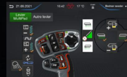
ASIGNACIÓN DE ISOBUS EN LA PALANCA MULTIPAD: es posible asignar directamente las funciones de los aperos ISOBUS de uso más frecuente a los controles MF MultiPac, lo cual ofrece un control táctil de las funciones del tractor y los aperos desde la misma palanca.
