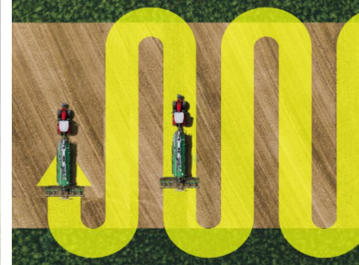
▲ **SPEEDSTEER** reduce el esfuerzo del conductor y permite girar con mayor rapidez para aprovechar al máximo el tiempo en la cabina. El operador puede ajustar la relación de dirección y seleccionar el número de giros del volante necesarios para un determinado ángulo de giro de la dirección.
