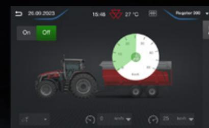
BLOQUEO AUTOMÁTICO DE LOS EJES DE DIRECCIÓN: esta funcionalidad le permite definir la velocidad a la que el tractor bloqueará automáticamente los ejes de dirección de un remolque, de modo que cuando salga a la carretera no tendrá que preocuparse por el bloqueo de los ejes. Lo mismo sucederá cuando active el control de potencia en marcha atrás, todo se llevará a cabo de forma automática.
